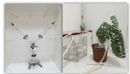
Dispositif avec olfactomètre en Y
